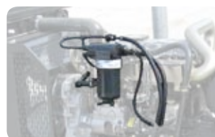
Топливный фильтр с подогревом
