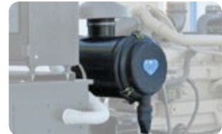
Слив конденсата из корпуса воздушного фильтра
