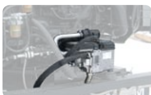
Предпусковой автономный подогреватель ОЖ (WEBASTO)
