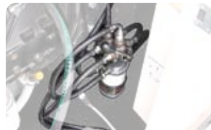
Система переключения между внешним и встроенным топливными баками
